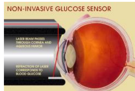
Sl.7 – Optičko (spektroskopsko) mjerenje glikemije [10]
